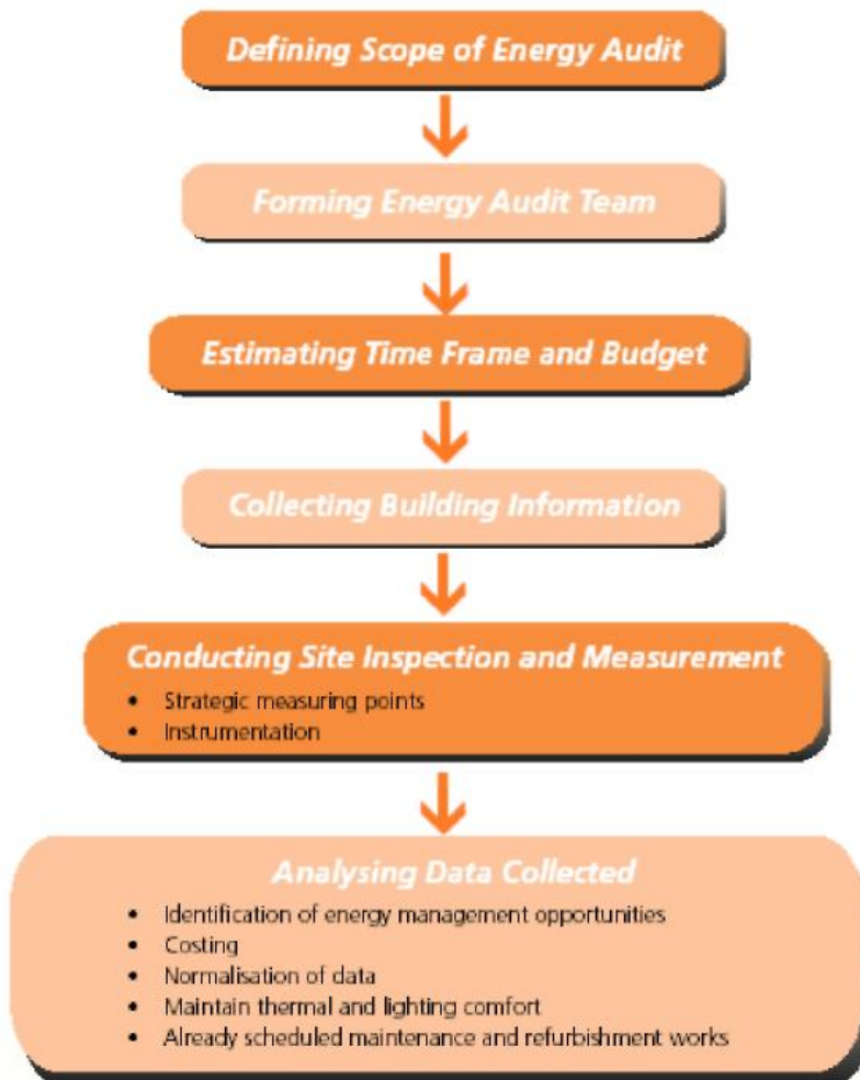
Abbildung 1: Ablaufschema für die Durchführung eines Energieaudits
